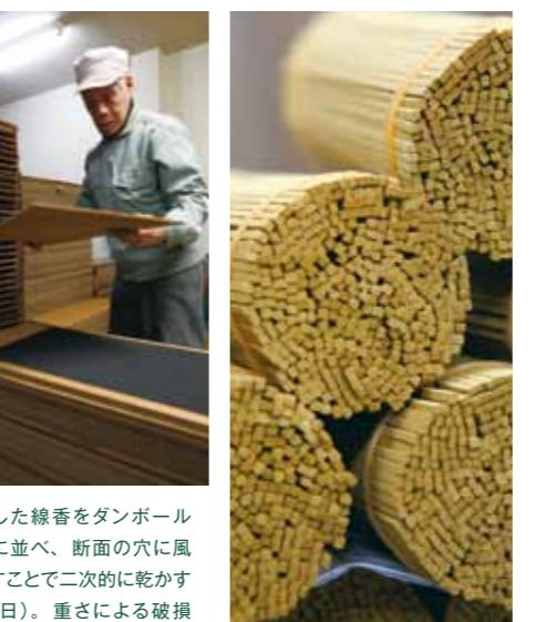
成型した線香をダンボールの板に並べ、断面の穴に風を通すことで二次的に乾かす（約3日）。重さによる破損が少ないというメリットも。
