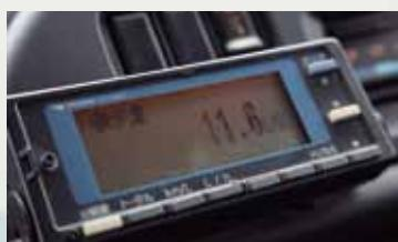
走行中の使用燃料が表示される計測器。アクセルを踏み込むと数字が高くなり、離すとゼロになる。
