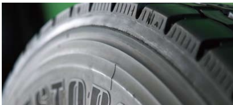
写真中央部の少し太めのラインがリトレッドの境界線。
