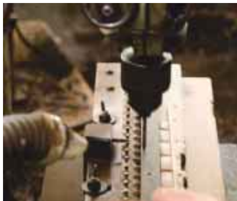
中棧と呼ばれる白い線が入った板の淵に、ひごを通す穴をつくる。
