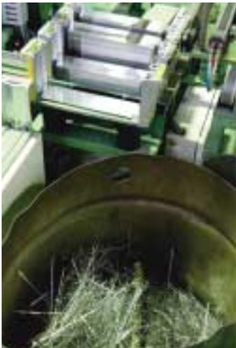
切り落とした部分は、製造上の基準面となる鋸の背の部分。
