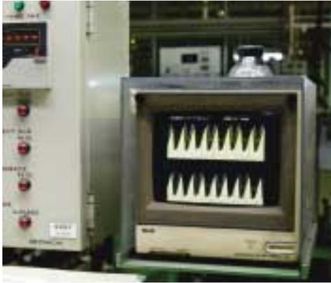
検査過程で、鋸の刃の削り具合をチェックする。
