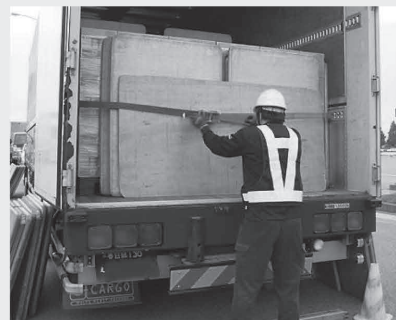
後方に隙間があればラッシングベルトで養生する
