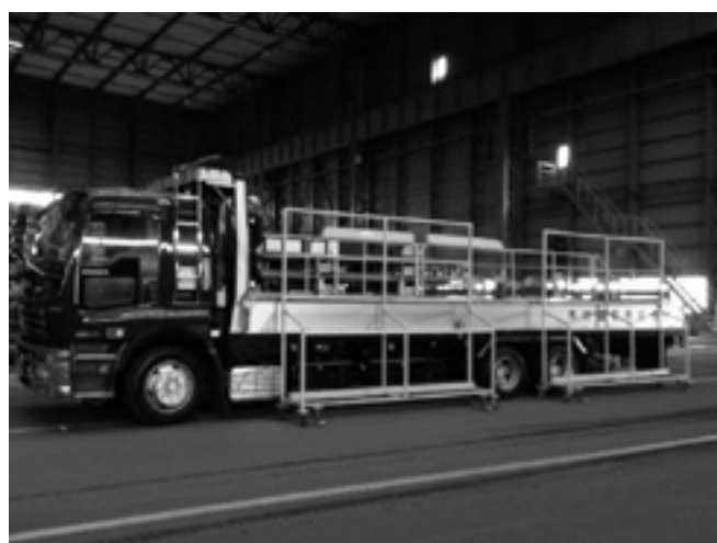
【例1】トラックの荷台からの墜落防止するための移動式安全柵(キャスター付き)
